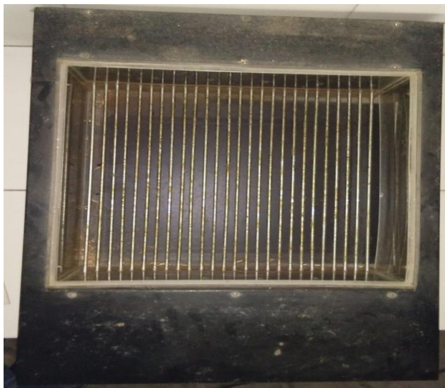
Fig. Actophotometer apparatus
